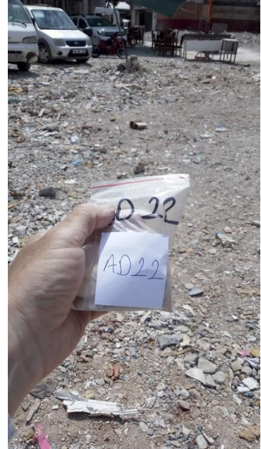
Şekil 11. Farklı özelliklerde noktalardan örneklemeler- a) Yıkımın örnekleme gününde devam ettiği bir nokta b) Yıkımın daha önce gerçekleştiği ancak hafriyatın kaldırılmadığı bir nokta c) Yıkımın daha önce gerçekleştiği ve hafriyatın kaldırıldığı bir nokta
